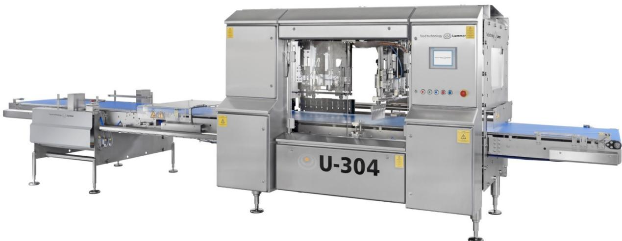
Ultraschallschneidelinie zum Schneiden von Ingwer-Bonbon
